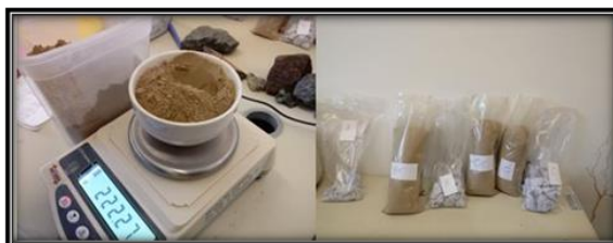
Figura 05: Pesagem das argilas utilizadas no trabalho.
